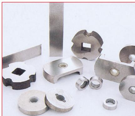
I magneti AlNiCo sono magneti permanenti, composti da una lega di Alluminio, Nichel e Cobalto, oltre a Ferro e altre tracce di elementi metallici. Questi magneti possono essere prodotti tramite un processo di sinterizzazione (per forme più piccole e complesse) o più comunemente di casting (fusione). Questi materiali hanno un'eccellente resistenza alle alte temperature e alla corrosione, e nonostante la bassa resistenza alla smagnetizzazione, sono principalmente usati in strumenti di precisione.
