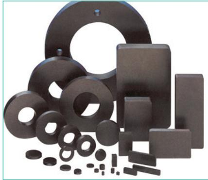
Grazie al processo produttivo e alle loro proprietà meccaniche, le ferriti sono anche note come magneti in ceramica. La polvere di ferrite (ossido di Ferro e carbonato di Stronzio - Sr - o Bario - Ba) viene pressata in un campo magnetico e in un secondo tempo viene sinterizzata. Disponibili in varie forme (cilindri, parallelepipedi, anelli, segmenti...), questi magneti offrono un ottimo rapporto qualità/prezzo, e costituiscono il gruppo di materiali magnetici più comunemente utilizzato.
