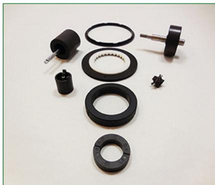
La plasto-ferrite iniettata è ottenuta tramite processo di stampaggio a iniezione, miscelando matrici plastiche con ossidi di ferrite.
